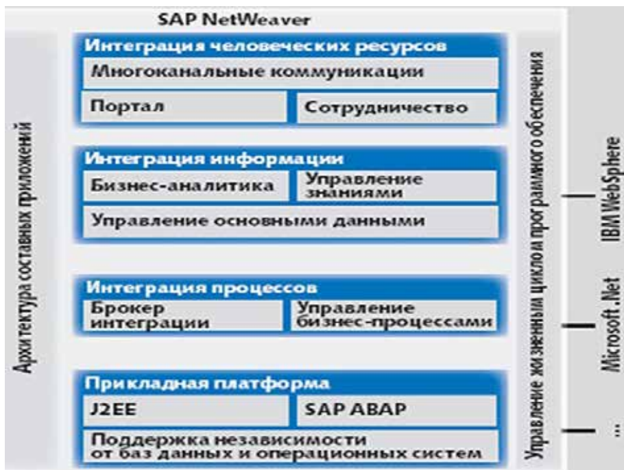
Архитектура составных приложений технологической платформы SAP Net Weaver [3]
