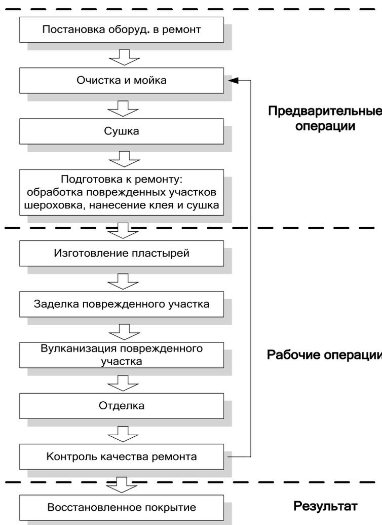
Рис. 3. Принципиальная схема технологического процесса управления качеством местного ремонта гуммированных покрытий
