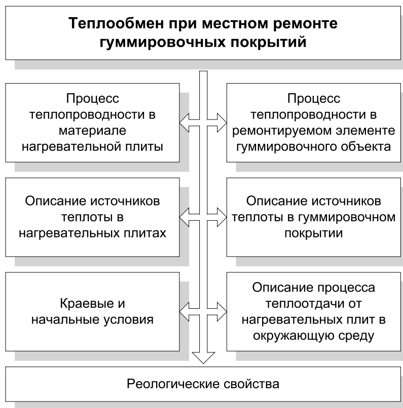
Рис. 1. Система математического представления процесса теплообмена при местном ремонте гуммированных объектов
