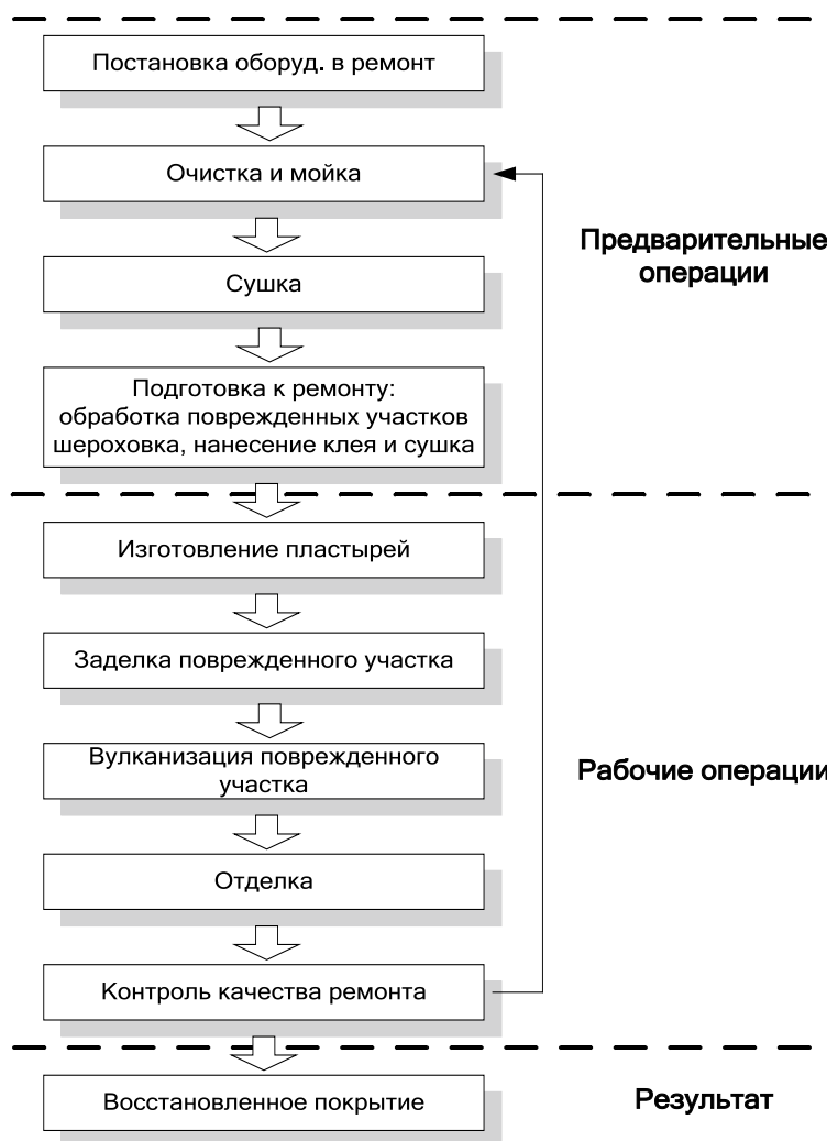
Рис. 3. Принципиальная схема технологического процесса управления качеством местного ремонта гуммировочных покрытий
