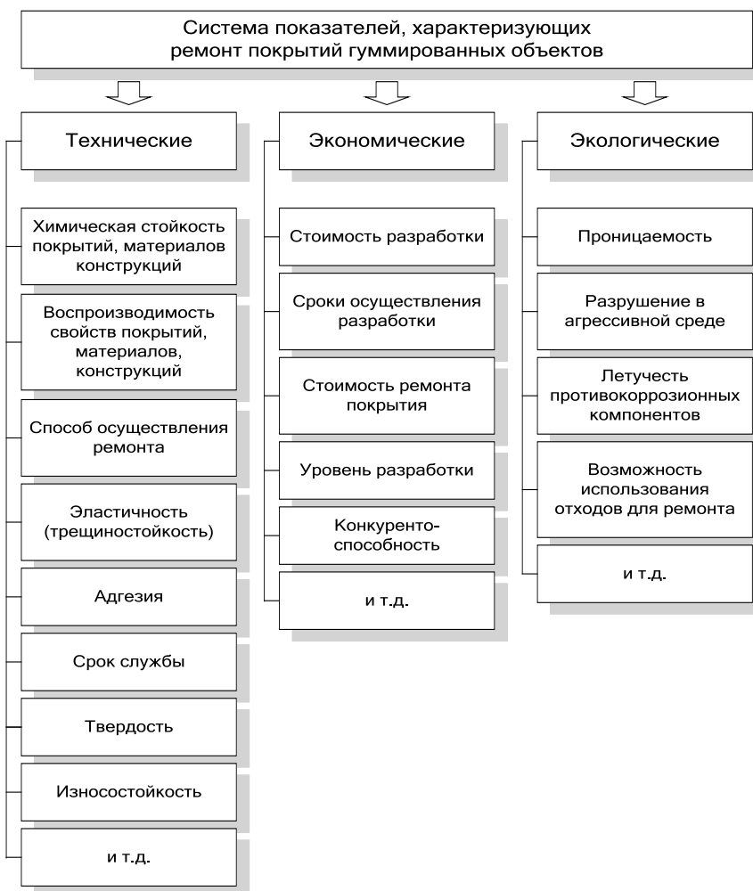
Рис. 4. Система показателей, характеризующих ремонт гуммированных объектов
