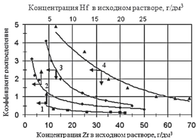
Рис. 2. Зависимость коэффициентов распределения от состава исходного раствора: 1, 2 – Hf; 3, 4 – Zr; 1, 3 – HNO<sub>3</sub> ~ 350 г/дм<sup>3</sup>; 2, 4 – HNO<sub>3</sub> ~ 390 г/дм<sup>3</sup>
