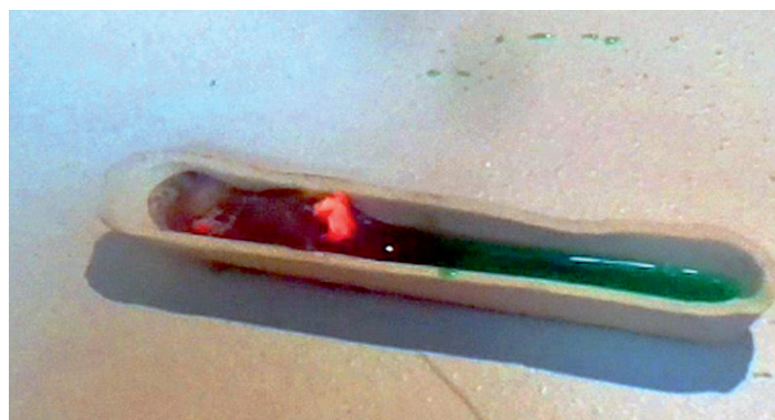
Рис. 2. Фронт горения в реакции системы «гексагидрат нитрата никеля – аминокусусная кислота»
