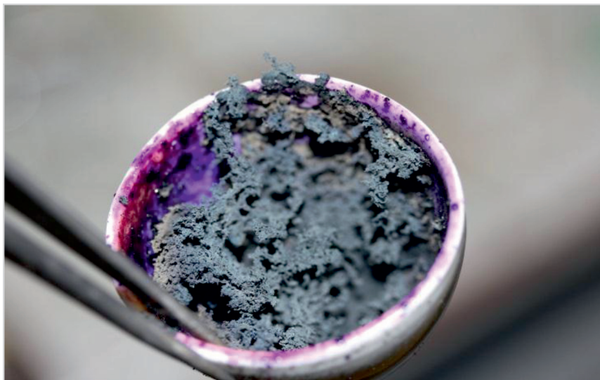
Рис. 3. Продукт горения системы «нитрат кобальта – диамид угольной кислоты» – оксид кобальта (II)
