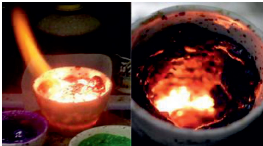
Рис. 1. Горение системы «гексагидрат нитрата железа (III) – диамид угольной кислоты»
