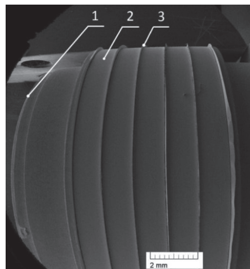
Рис. 1. Автоэмиссионный комбинированный МПК: 1 – kern катода, 2 – вторично-эмиссионный эмиттер, 3 – автоэмиссионный эмиттер
