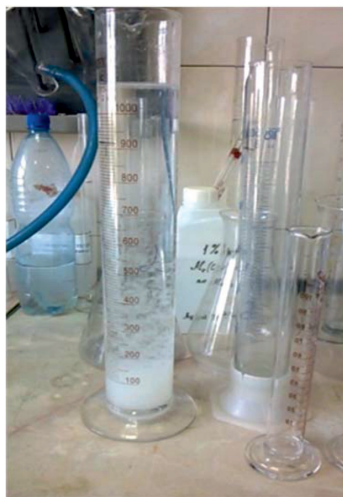
Рис. 2. Образование осадка в цилиндре в результате применения едконатрового метода умягчения совместно с оксихлоридом алюминия
