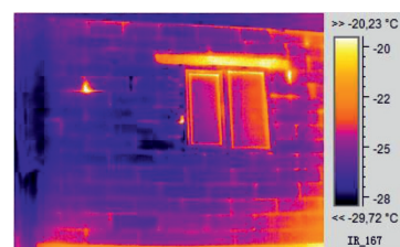
Обследование качества кладки стеновых пеноблоков: д – вид изнутри, е – наружная часть стены
