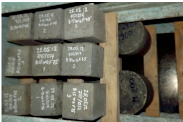
Рис. 3. Бетонные образцы в процессе замачивания
