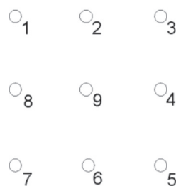
Точки замера в сечении вытяжной решетки вентиляционного канала
