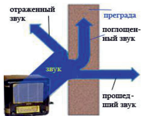
Принцип действия материала для защиты от шума
