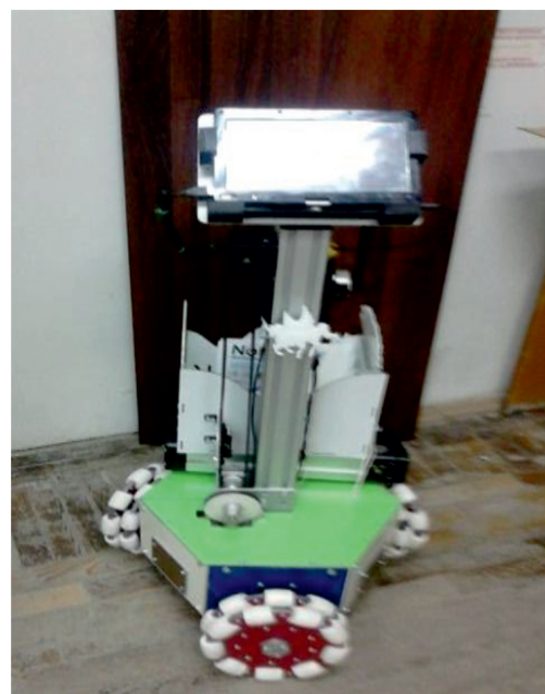
Рис. 2. Мобильное робототехническое устройство для числовой линии с возможностью произвольного перемещения
