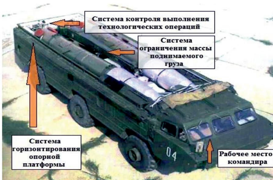
Рис. 1. Оснащение РК новейшими адаптивными системами контроля
