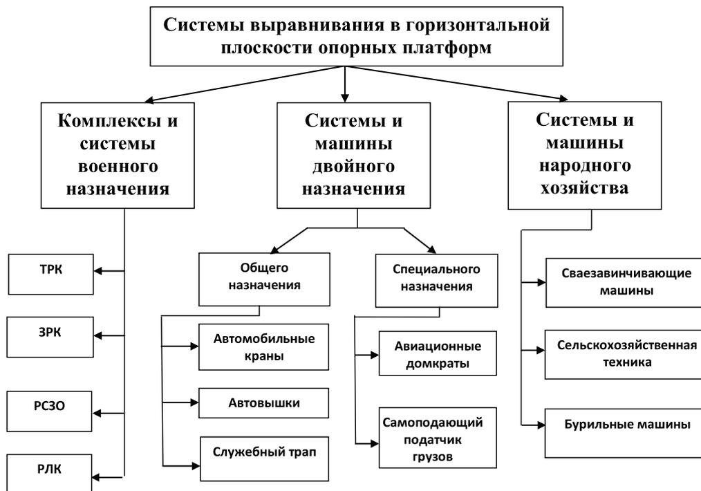
Рис. 2. Классификация систем выравнивания опорных платформ
