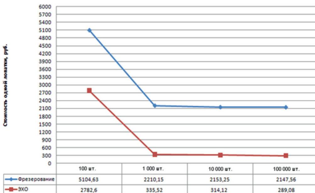
Рис. 7. Сравнительный график затрат на изготовление одной детали в зависимости от количества выпущенных лопаток
