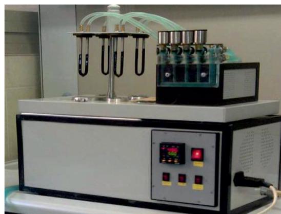
Рис. 1. Установка для оценки эффективности ингибиторов парафиноотложений
