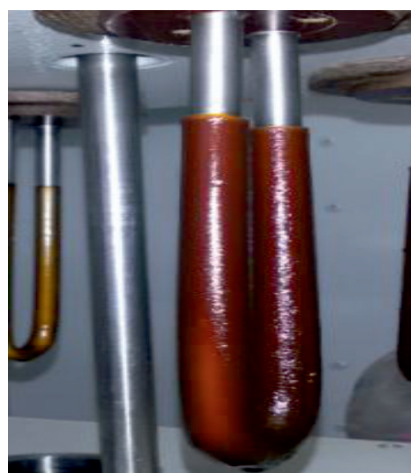
Рис. 6. Вид отложений после добавления парафина
