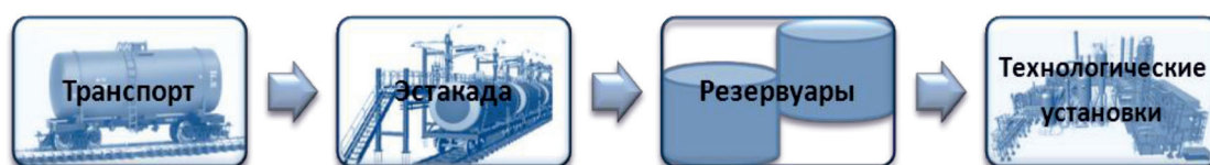
Рис. 1. Схема потока сырья, поступающего на железнодорожную эстакаду слива, в резервуарный парк и на переработку
