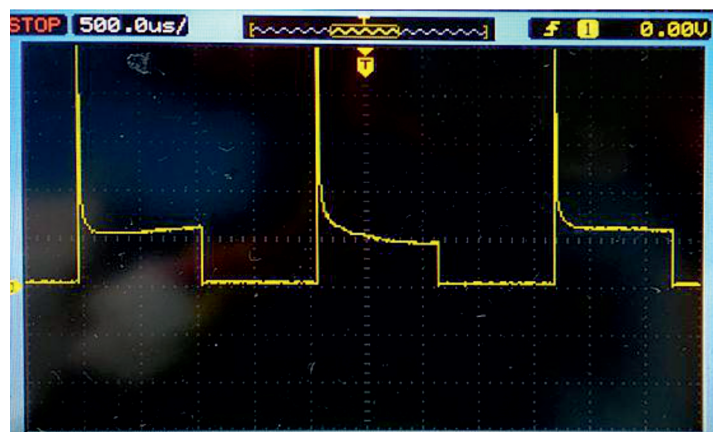
Рис. 3. «Всплеск» напряжения при закрытии транзисторного ключа (Желтая линия – напряжение (20 В/дел))
