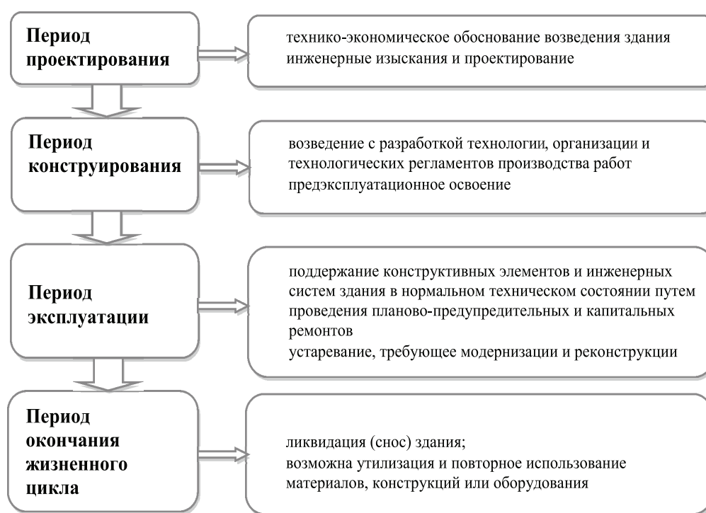
Рис. 2. Периоды жизненного цикла здания
