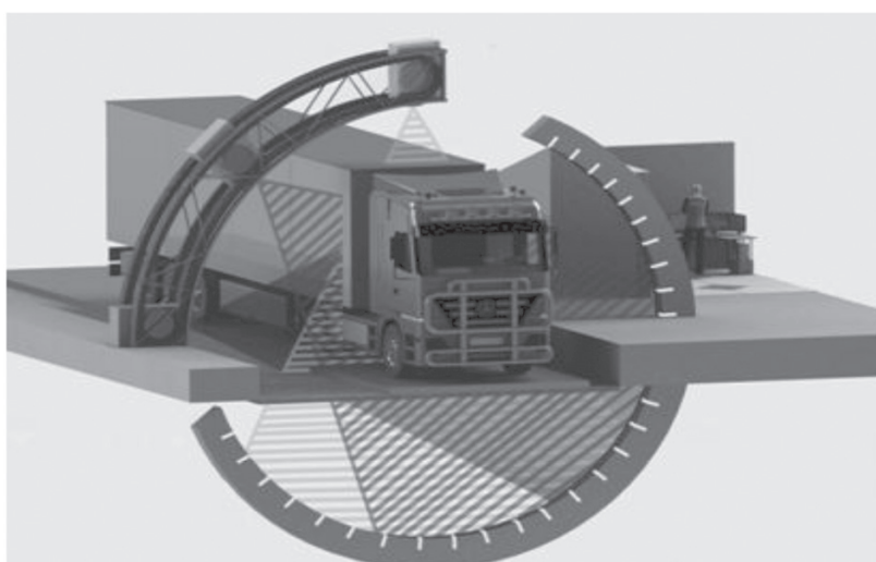
Рис. 2. Внешний вид стационарного ИДК с детекторной линейкой в виде части окружности
