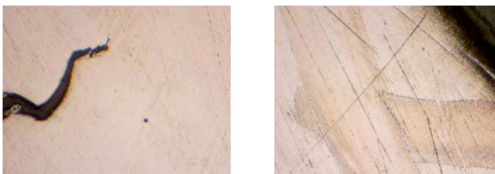
Рис. 8. Изображение объемного образца, синтезированного из порошка Ni-Cr
