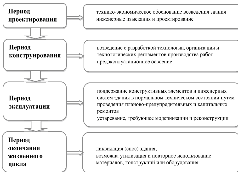
Рис. 2. Периоды жизненного цикла здания
