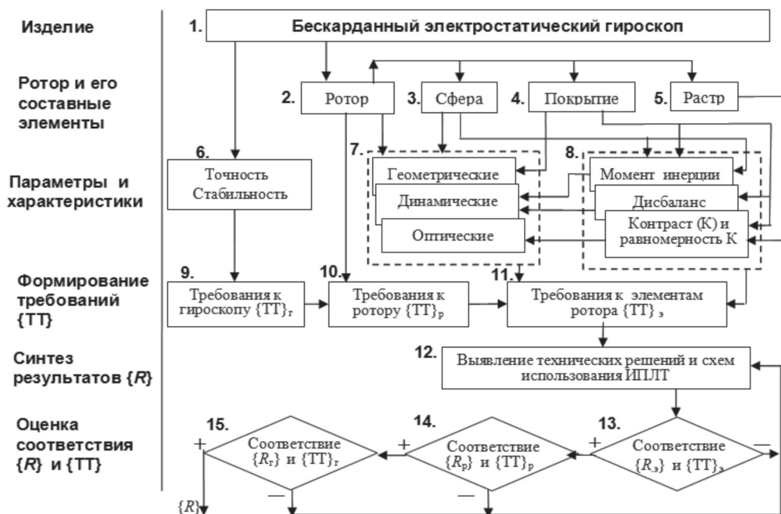
Рис. 1. ИЛМ технологического проектирования процесса изготовления ротора
