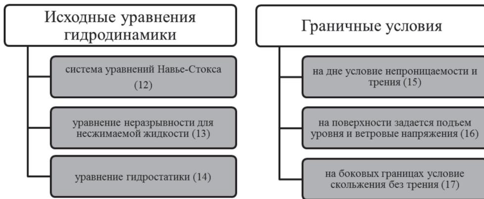
Рис. 5. Исходные уравнения математической модели волновых процессов, учитывающей наличие надводных береговых сооружений
