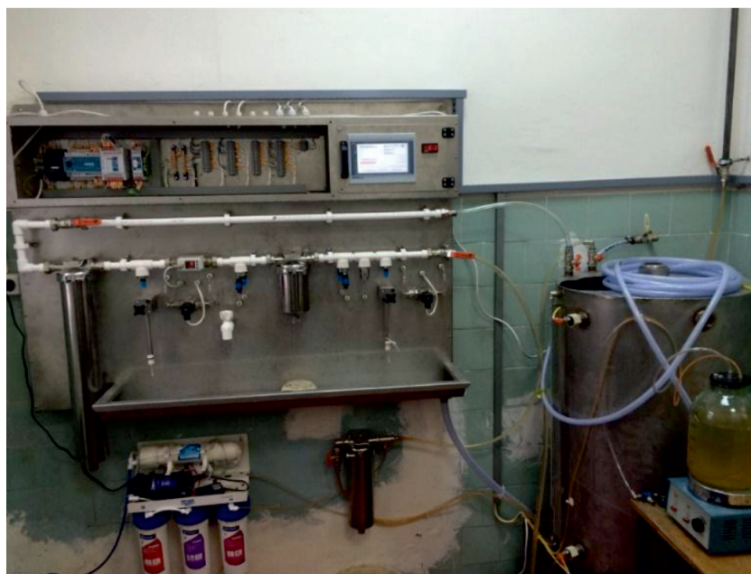
Рис. 2. Лабораторный стенд контроля качества фильтров для жидких сред
