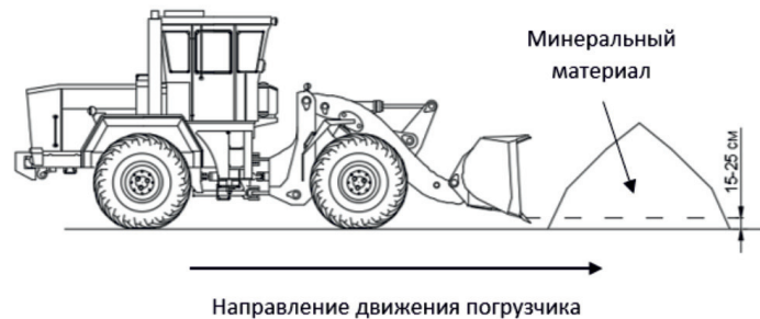
в) Схема работы фронтального погрузчика исходных компонентов
