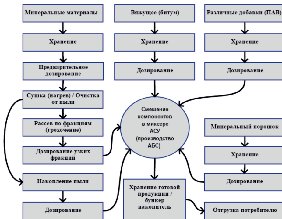
Рис. 2. Принципиальная схема технологического процесса приготовления асфальтобетонных смесей на АСУ
