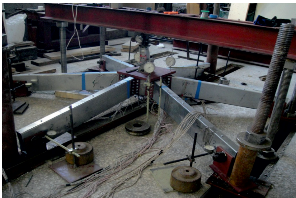
Рис. 2. Узловое соединение и испытательная установка
