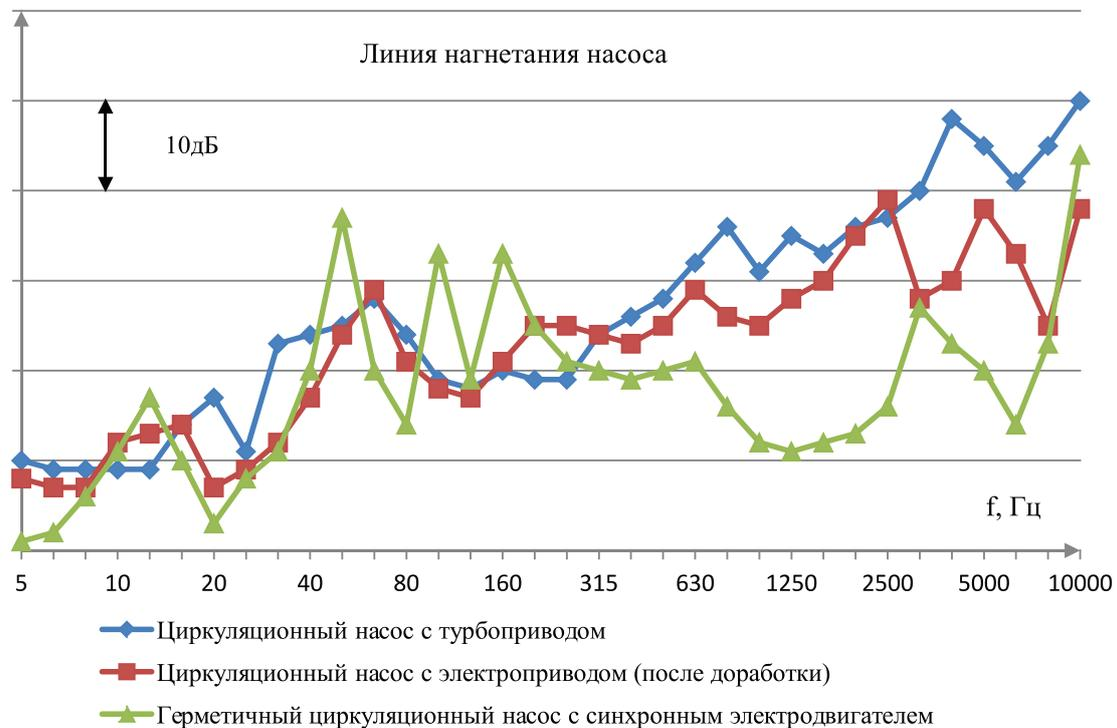
Рис. 3. Спектрограммы вибрации нагнетательного патрубка циркуляционных насосов в горизонтальном направлении
