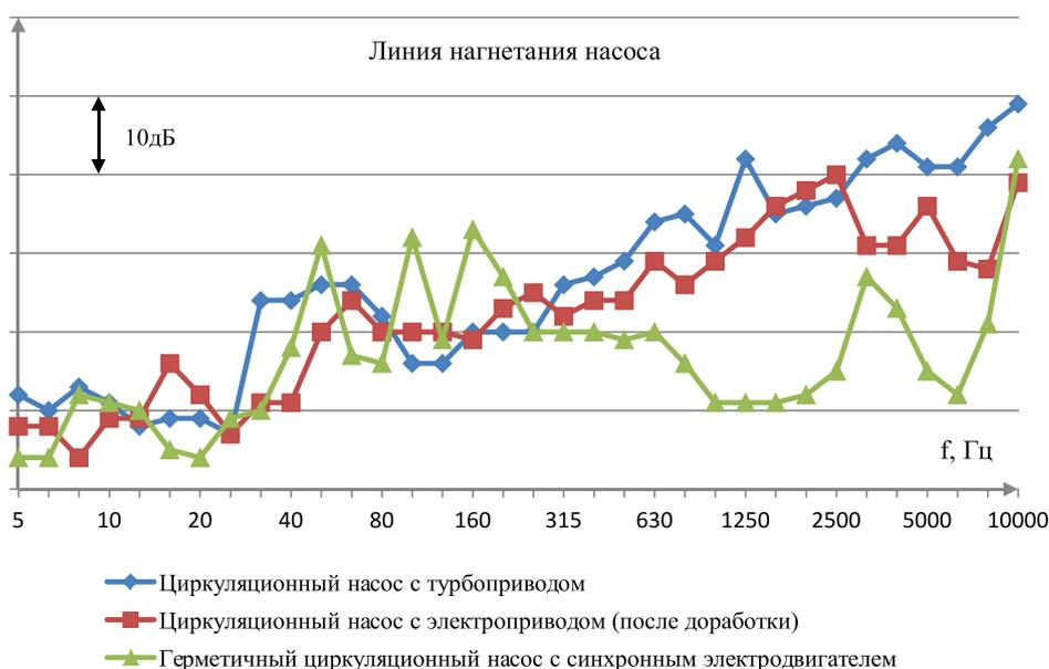
Рис. 5. Спектрограммы вибрации нагнетательного патрубка циркуляционных насосов в вертикальном направлении
