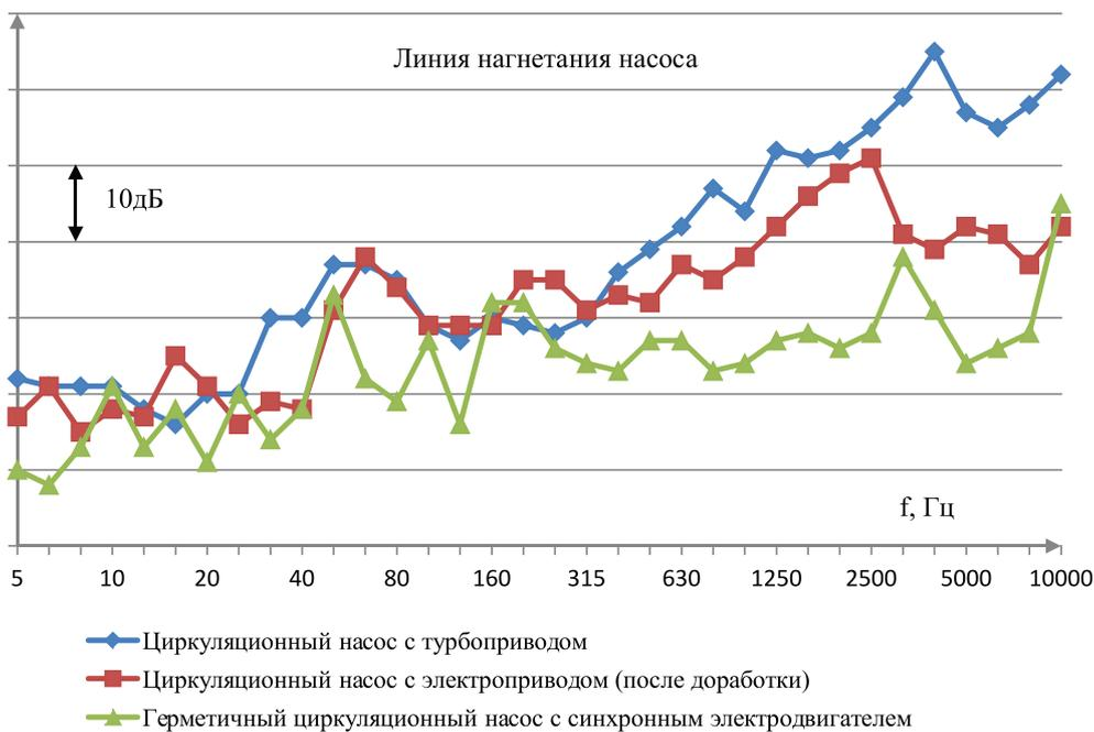
Рис. 4. Спектрограммы вибрации нагнетательного патрубка циркуляционных насосов в осевом направлении
