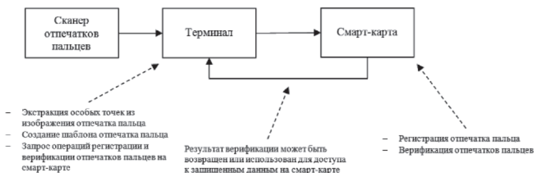
Рис. 1. Распределение задач в системе Match-on-Card
