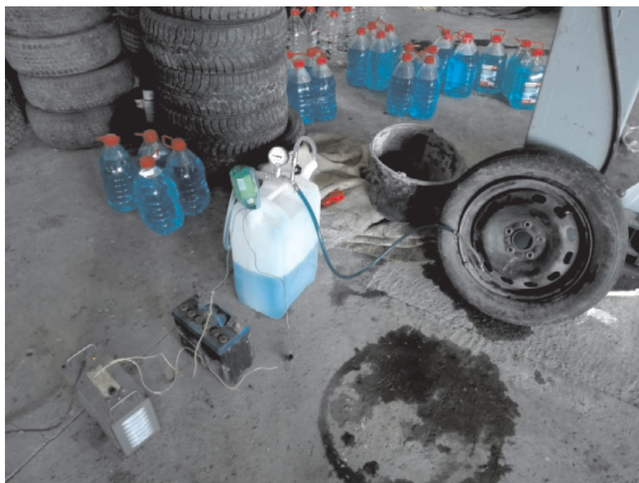
Рис. 4. Проведение эксперимента по заполнению колеса теплоносителем по методике, разработанной кафедрой «Транспортные и технологические системы»
