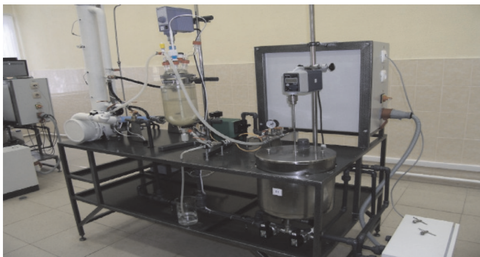
Рис. 1. Экспериментальный роторно-пленочный испаритель с шарнирно закрепленными лопатками
