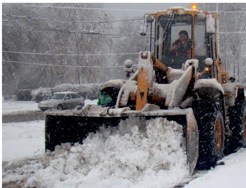
Рис. 1. Работа фронтального погрузчика при сгребании снега
