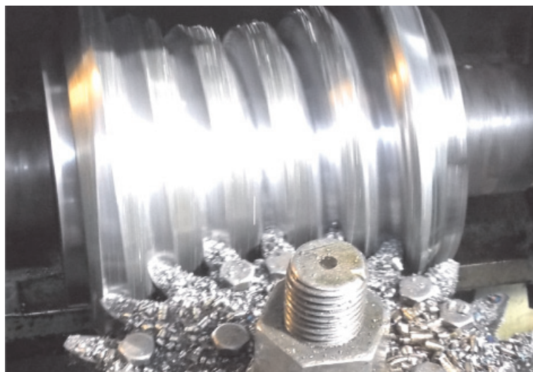
Рис. 1. Процесс обработки глобoidной винтовой поверхности вогнутого профиля
