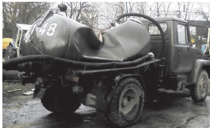
Рис. 1. Разрушение ассенизационной емкости вакуумной машины
