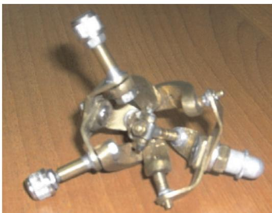
Рис. 8. Сферический механизм
