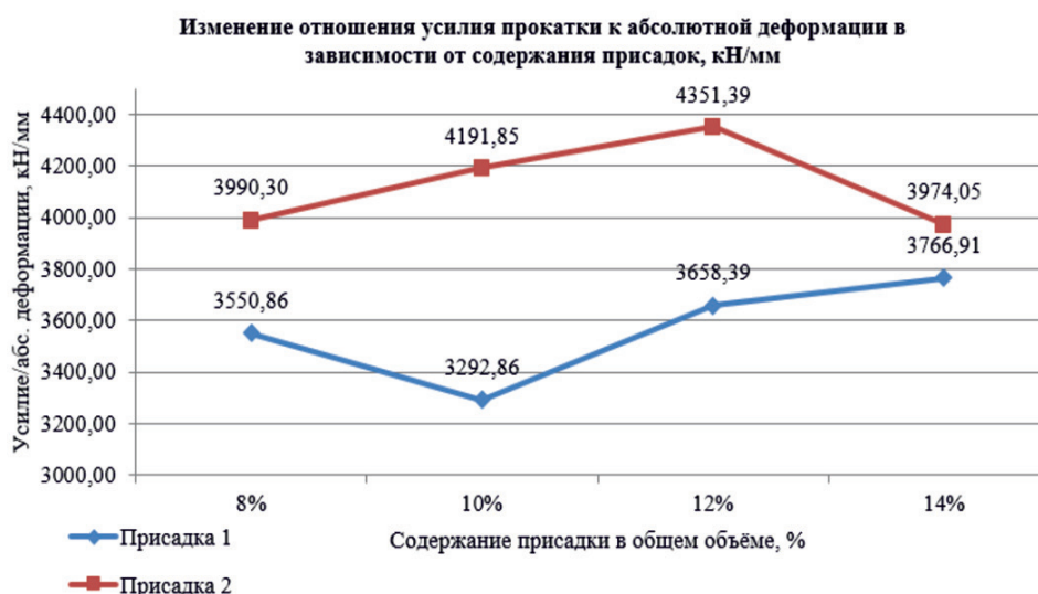
Рис. 5. Изменение отношения усилия к абсолютной деформации в зависимости от содержания присадок
