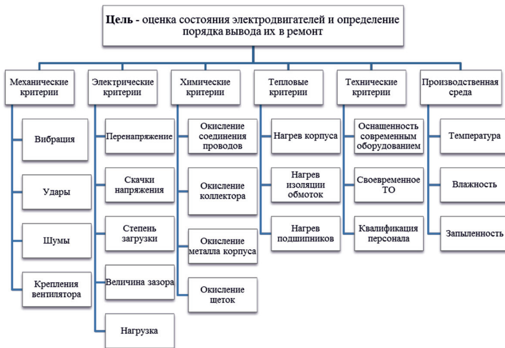
Иерархическая структура критериев оценки технического состояния электродвигателя
