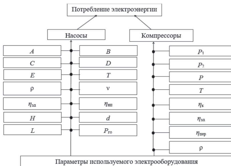
Рис. 1. Структура влияющих на электропотребление параметров
