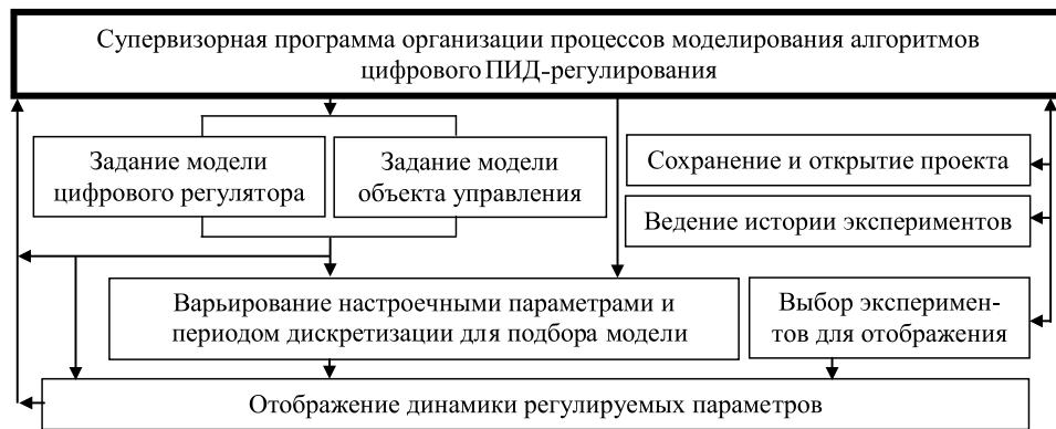
Рис. 2. Функционал инструментария моделирования алгоритмов цифрового ПИД-регулирования
