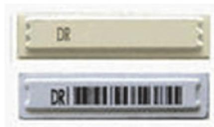
Рис. 4. Внешний вид акустомагнитной метки. Этикетка LE, Размер: 10×44 мм; рабочая частота: 58 КГц; вид: белая, с ложным штрих-кодом; 2 контура
