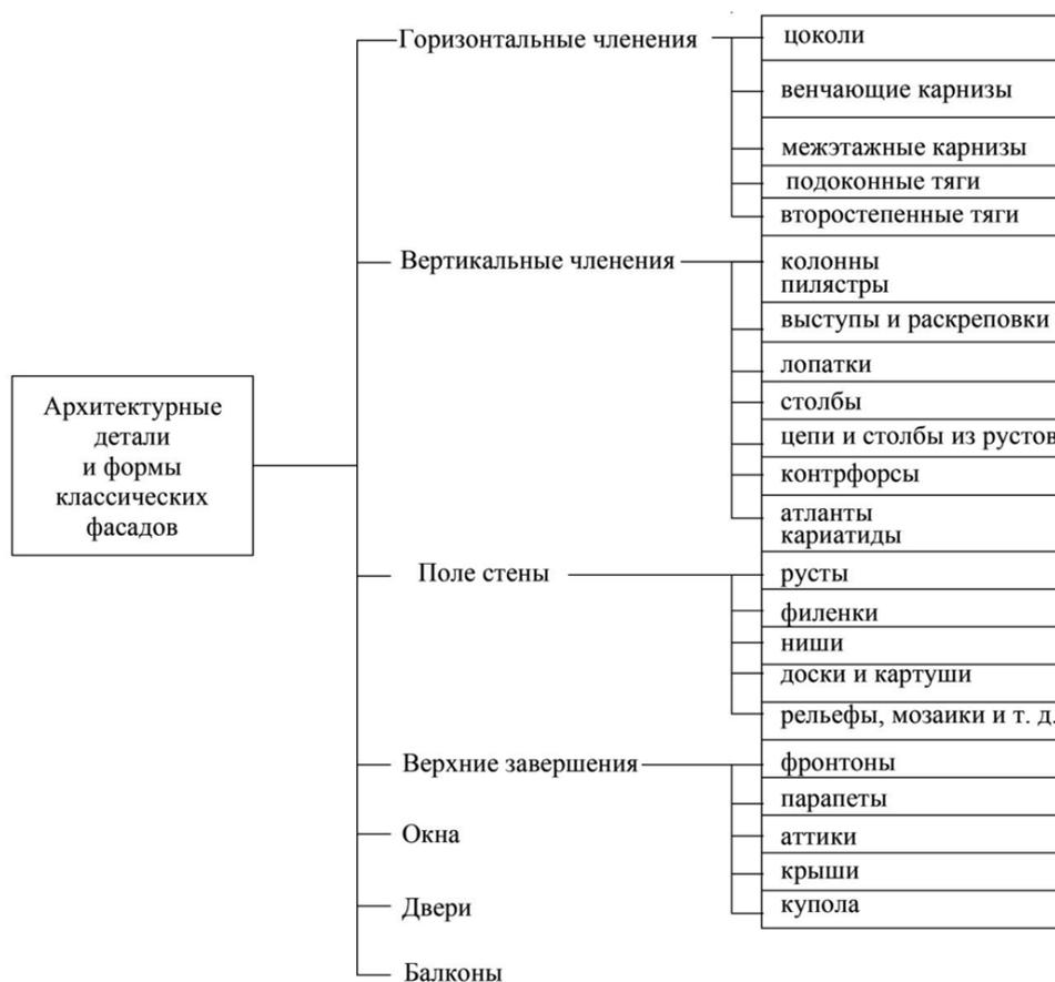
Рис. 1. Систематизация классических архитектурных форм по месторасположению на фасаде
