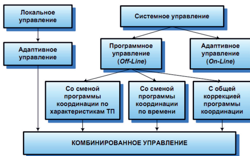
Классификация методов управления транспортными потоками
