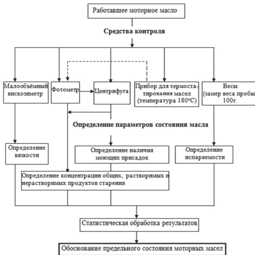
Рис. 7. Схема определения и обоснования предельного состояния работающих моторных масел
