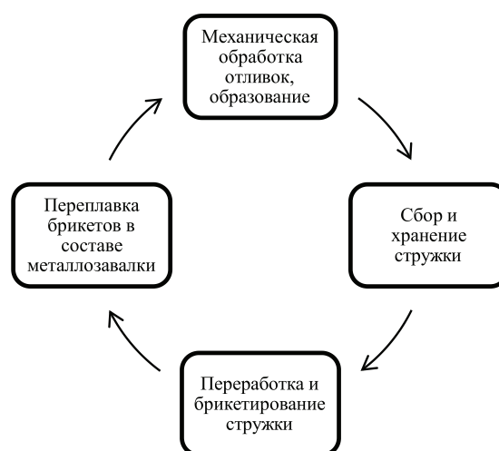
Кругооборот стружки в процессе производства и механической обработки чугунных отливок
