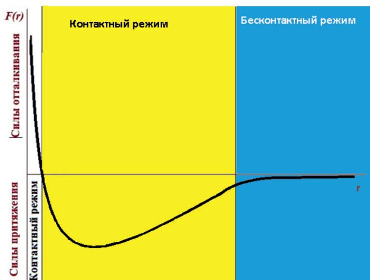
Рис. 1. Схематическое изображение характера изменения Ван-дер-Ваальсовских сил взаимодействия двух тел в зависимости от расстояния
