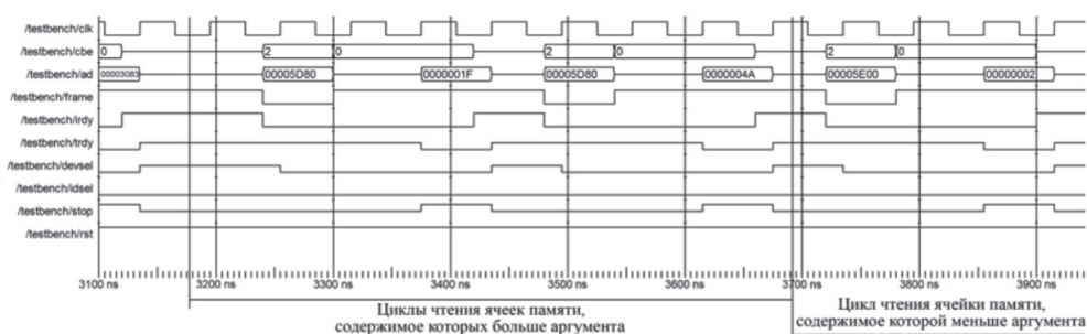
Рис. 3. Временные диаграммы работы ассоциативного сопроцессора: конфигурирование устройства (а); запись в ячейки памяти (б); запись в аргумент поиска, фиксация совпадений и чтение количества совпадений (в); чтение из ячеек памяти, содержимое которых больше и меньше аргумента (г)
