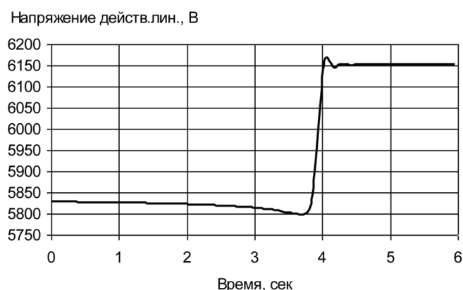
Рис. 4. Напряжение сети при пуске АД
