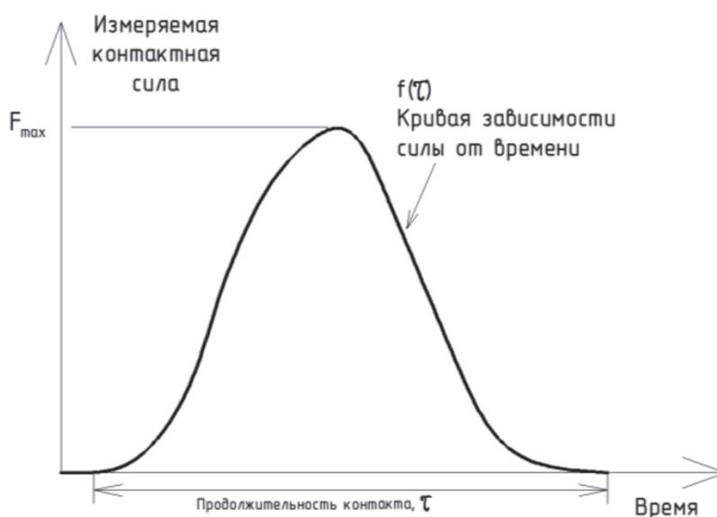
Рис. 1. Модельная кривая зависимости силы ударника от времени
