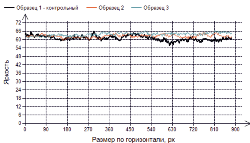
Рис. 7. Средняя яркость по ширине образца ЭД-20 + АФ-2 + портландцемент
