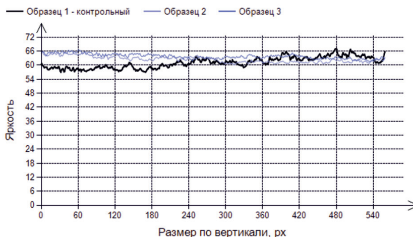
Рис. 8. Средняя яркость по высоте образца ЭД-20 + АФ-2 + портландцемент
