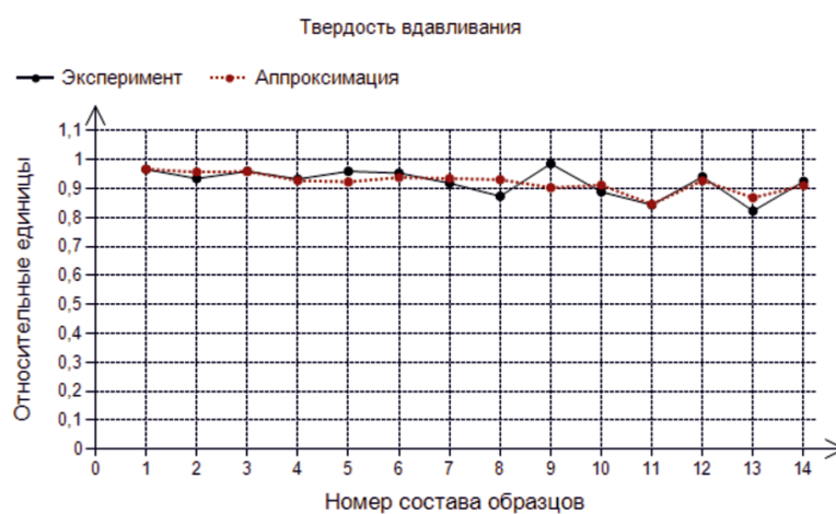
Рис. 14. Аппроксимация показателя «Твердость вдавливания»
