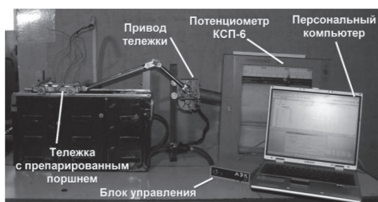
Рис. 4. Безмоторная экспериментальная установка для исследования термостойкости поршней
