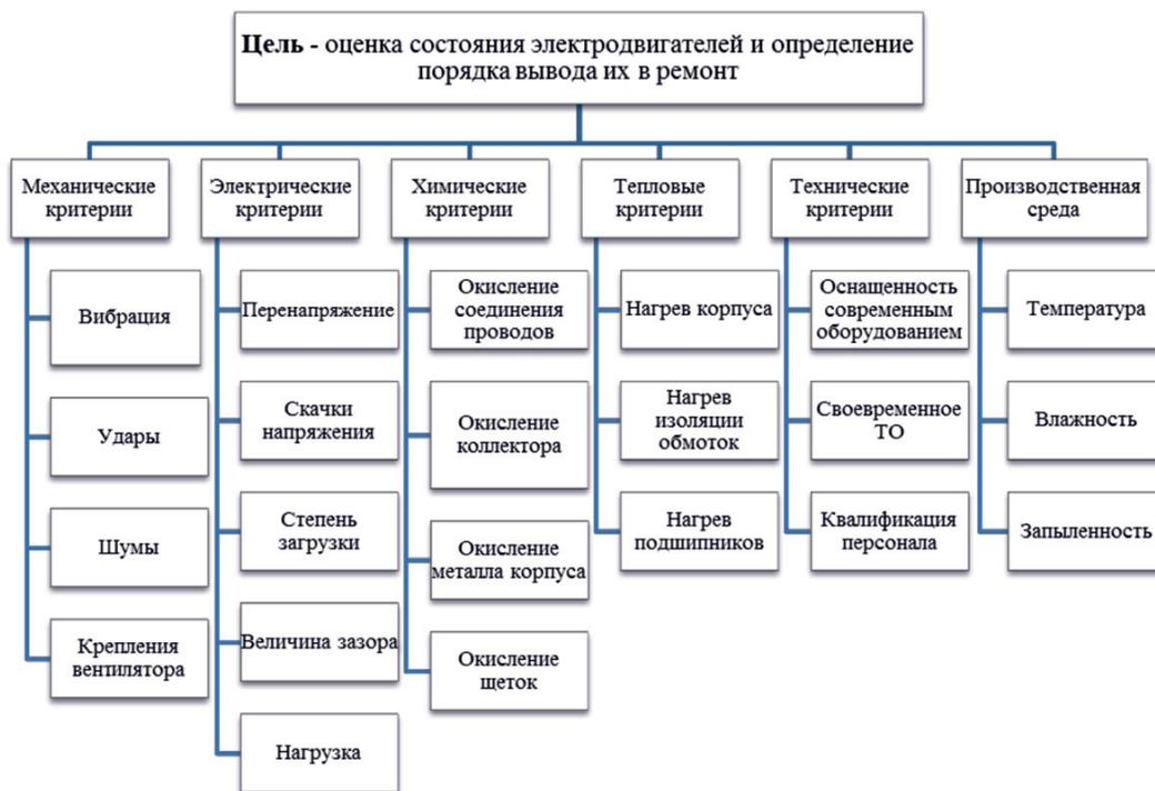
Иерархическая структура критериев оценки технического состояния электродвигателя
