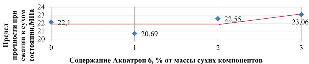
Рис. 3. Зависимость предела прочности при сжатии в сухом состоянии от количества вводимой добавки
