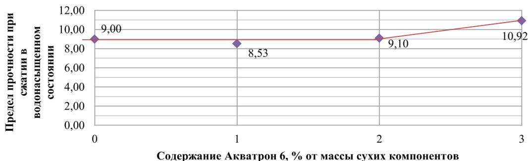
Рис. 4. Зависимость предела прочности при сжатии в водонасыщенном состоянии от количества вводимой добавки
