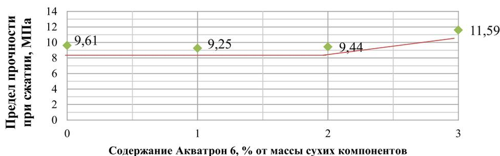
Рис. 2. Зависимость предела прочности при сжатии от количества вводимой добавки
