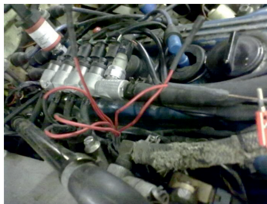
Рис. 1. Датчик давления, вкрученный в свечное отверстие цилиндра двигателя ЗМЗ-4062
