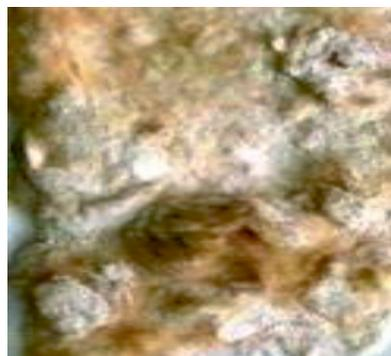
Рис. 2. Смесь полиакрилонитрильной фибры 2,5% с минеральным порошком 97,5% после перемешивания с нагревом до 210 °С
