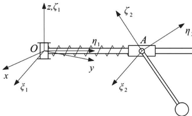
Введём неподвижную  $Oxyz$  и связанные где с телами  $O\xi_1\eta_1\zeta_1$ ,  $O\xi_2\eta_2\zeta_2$  системы координат, как показано на рисунке. Система состоит из двух тел с массами  $m_1$  и  $m_2$  и осевыми моментами инерции  $J_{1x}$ ,  $J_{1y}$ ,  $J_{1z}$  и  $J_{2x}$ ,  $J_{2y}$ ,  $J_{2z}$ . Предположим, что:
